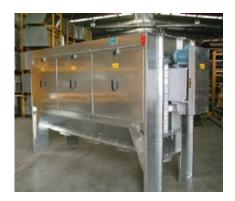
Le nettoyeur rotatif à grilles de la marque Borghi combine un tambour rotatif efficace et d'un système d'aspiration efficace. Par conséquent, il convient parfaitement au pré-nettoyage, au nettoyage de tous types de céréales.
